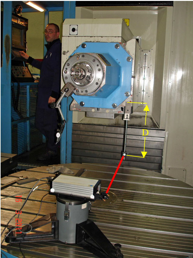
Fig.5 Misura dell'errore di posizionamento con sbraio. Il laser è nella posizione Bassa, mentre la macchina è nella posizione Alta. Il retroriflettore è collegato con una barra di estensione alla macchina.
